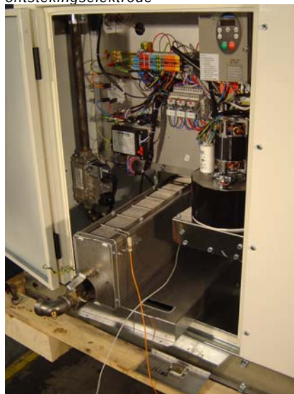
Figuur 24 Verwijder branderhuis, vlamvoeler en ontstekingselektrode
